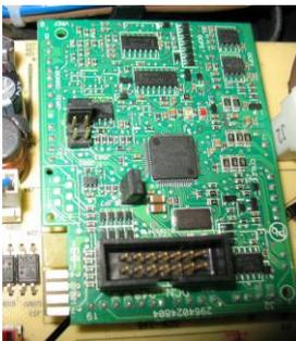
Las IPCs deben ser direccionadas en función de su posición (izquierda o derecha) para que funcionen correctamente. Este direccionamiento se realiza mediante los pines indicados en la imagen.
