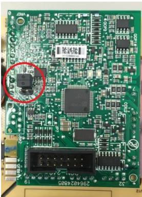
En el caso de los módulos dómino, cuando se sustituye únicamente la IPC se debe direccionar con 2 puentes como se indica en la foto.
