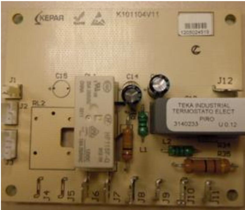
Cuando la función de pirólisis se selecciona todos los relés del TC deben estar abiertos. Para activar el programa de sincronización para Pyro (P1, P2, P3), el terminal J6 (placa TC) debe recibir la señal neutra, mientras que J5 (placa TC) debe permanecer sin ninguna señal. Se ha eliminado el RL2 de la PCB. La señal llega J6 como sigue:
