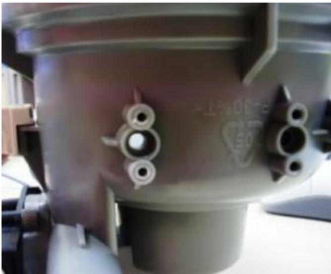
El bloque hidráulico es el núcleo del sistema hidráulico. Conecta el agua del descalcificador (agua entrante), el agua que va recircular de nuevo y el agua que va a salir del sistema.
