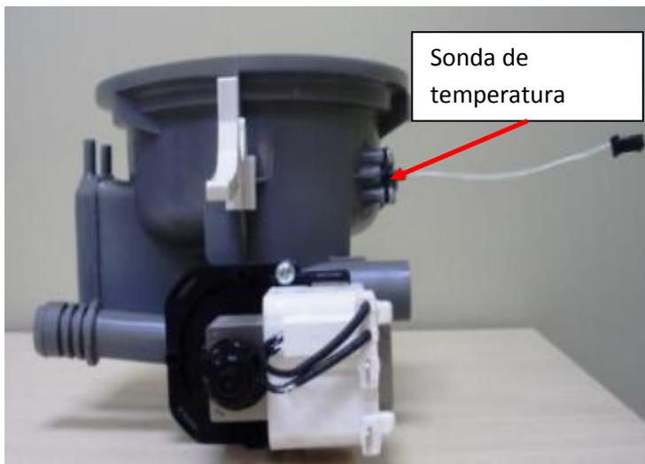
El bloque hidráulico del lavavajillas está situado en la parte inferior del lavavajillas y es ahí dónde va el agua desde el ciclo de descalcificación y de lavado. El agua circulará de nuevo o será desaguada del lavavajillas.
