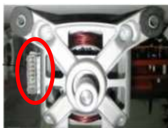
Figura 2 Ubicación del conector del motor
