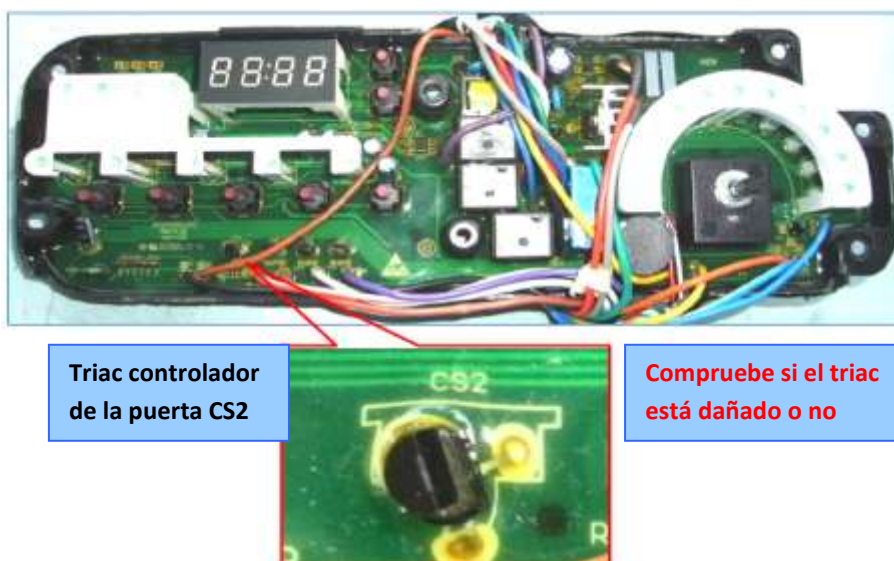
Figura 3 Ubicación del TRIAC que controla el cierre de puerta en la placa electrónica tipo B
