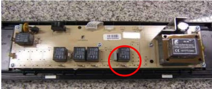
La función del condensador C9 en el control electrónico es eliminar los picos transitorios en los contactos del relé RL8 (control gira-platos), causados por la conmutación de la carga inductiva del motor del plato. En las primeras etapas de desarrollo del control electrónico, C9 no estaba presente y estos picos transitorios fueron la causa de un extraño efecto visual en el display, produciendo el reinicio del micro-controlador en algunos casos.
