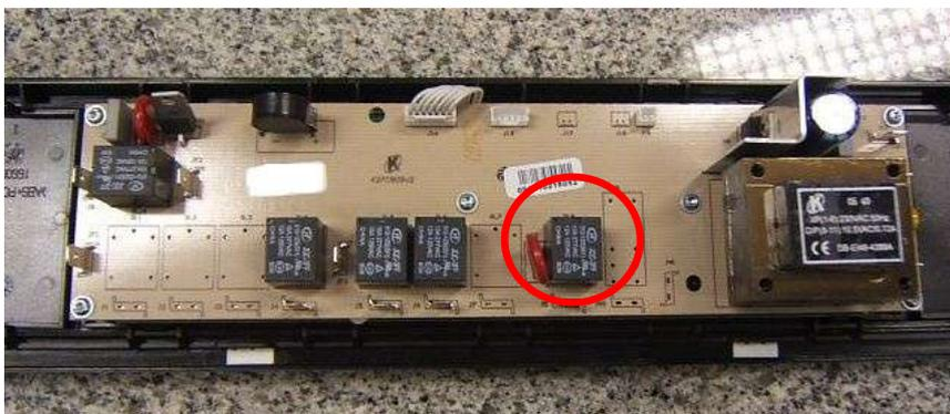
En el campo, si el horno trabaja correctamente y se detiene, siendo necesario desconectar de la red eléctrica para reiniciar, el modulo electrónico debe ser sustituido por uno nuevo con varistor, como se muestra en la imagen anterior.
