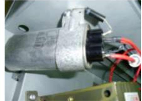
2. Verificar continuidad del filamento y resistencia entre terminales. El valor debe ser de un ohmio o menos. Si este es el caso, el filamento no está abierto.
