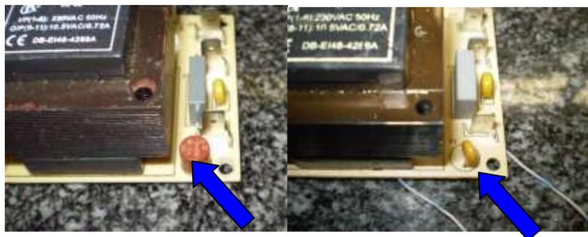
Fig.1 Modulo Electrón. Con fusible 100 mA Fig.2 Modulo Electrón. con PolySwitch
