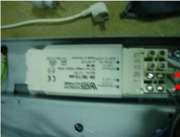
Conectar los terminales del multímetro a las salidas del transformador y medir el voltaje
