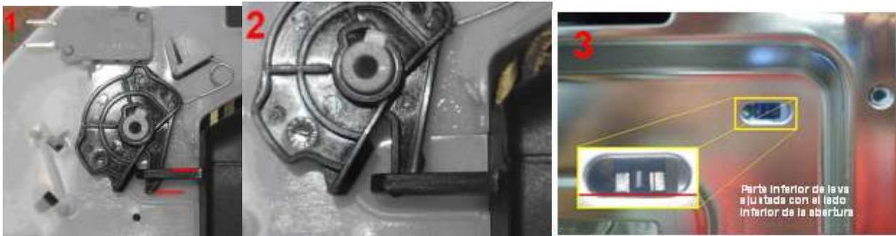
Con estas mejoras, la adecuada acción estará asegurada en la leva, resultando en una buena estabilidad de trabajo. La posición extrema de trabajo, será controlada por el gancho, sin posibilidad de retorno a la posición de seguridad, después de retirado el gancho.
