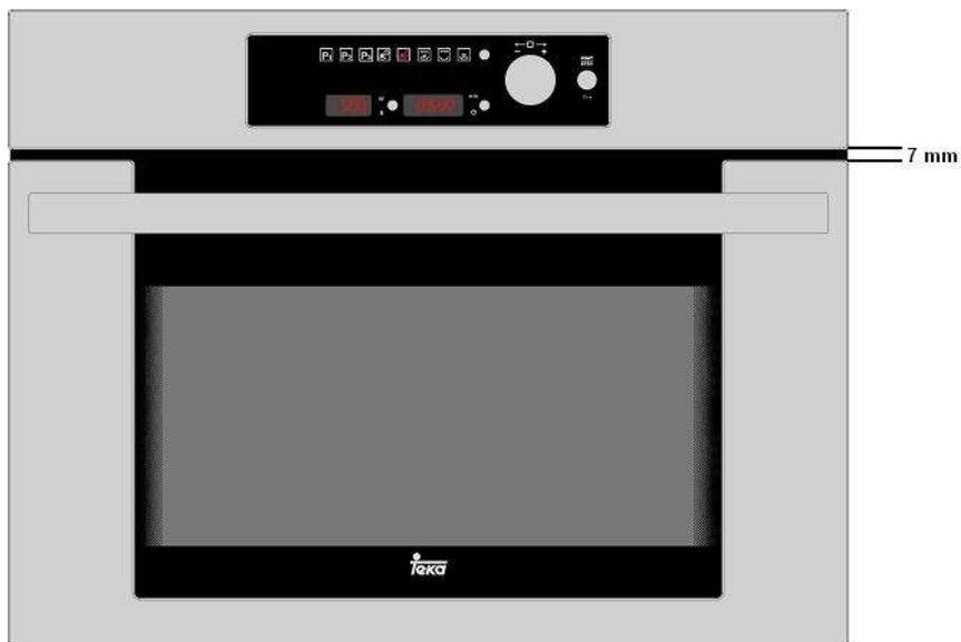
Se puede ajustar la puerta cuando está colocada en el horno. Esto es posible quitando los tornillos del soporte de la bisagra para aflojar la puerta. Seguidamente, ajustar la puerta al panel dejando 7mm en medio y apretar de nuevo los tornillos.
